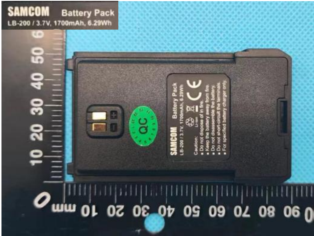
Battery / 电池 (LB-200 3.7V 1700mAh 6.29Wh)
